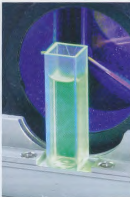
1 Fluoreszierende Farbstofflösung in einer Küvette. Im Hintergrund an einem Strahlteiler-aufbau ist das blaue Anregungslicht zu erkennen und davor die grün fluoreszierende Farbstofflösung
